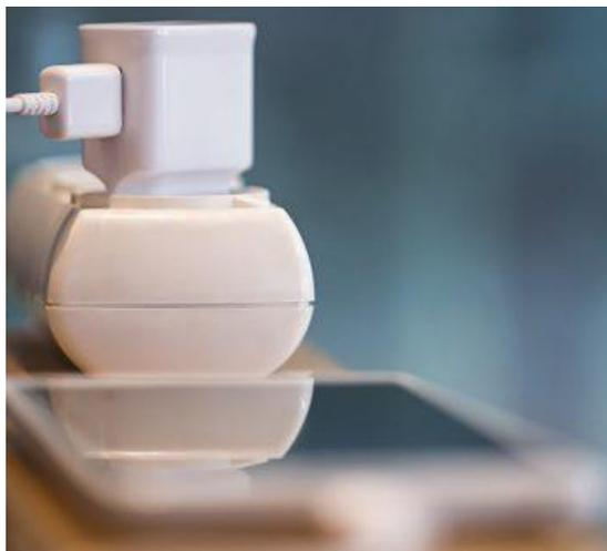
Se a luz não acender, ligar um carregador de telemóvel à tomada / extensão. Se o telemóvel carregar, o problema é da própria máquina ou do carregador. Experimentar com o carregador da outra máquina.
