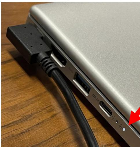
Garantir que a máquina está ligada ao carregador, que por sua vez está ligado a uma tomada elétrica funcional e verifique se a luz de carregamento se acende.
